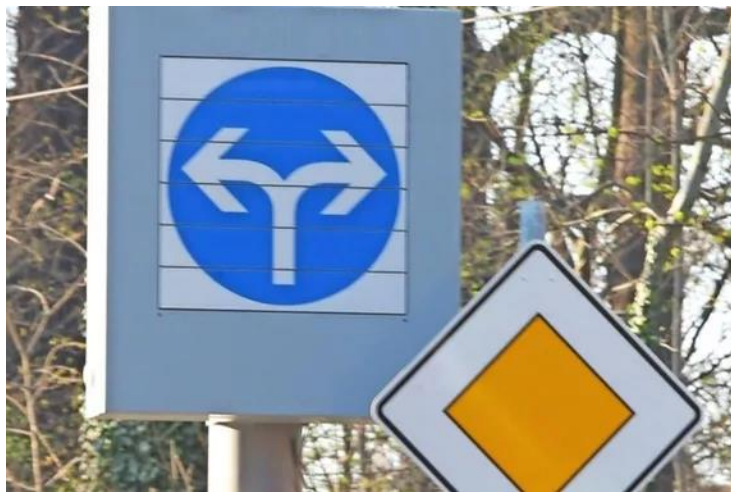
Abbildung: Beispiel für ein innerstädtisches Wechselverkehrszeichen mit Prismen-Technik (alternativ wäre auch ein elektronisches Wechselverkehrszeichen denkbar)
